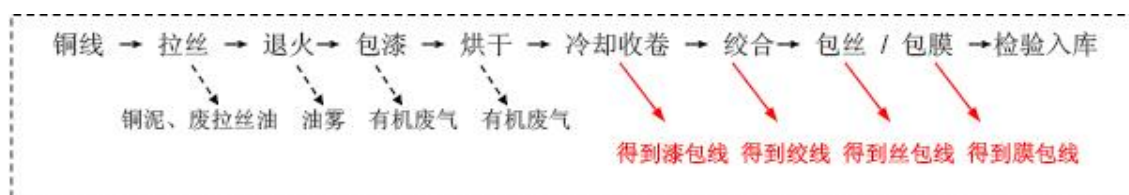
图 3.1-1 铝镁合金线生产工艺及产污环节图
