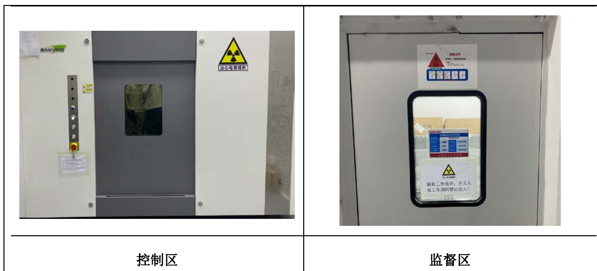
图 3-3 辐射工作场所布局分区照片
