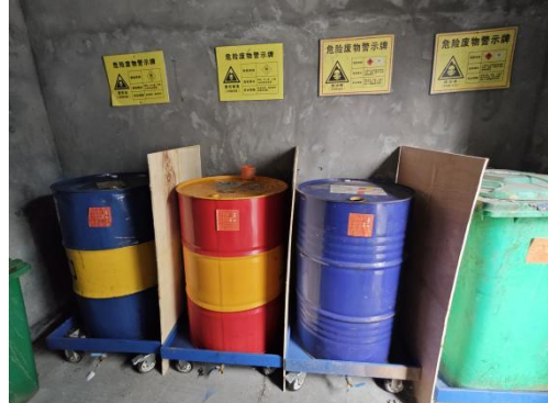
图 3-29 危废收集桶（含防渗托盘）
