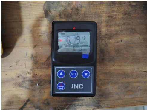
图 3-24 个人剂量报警仪
