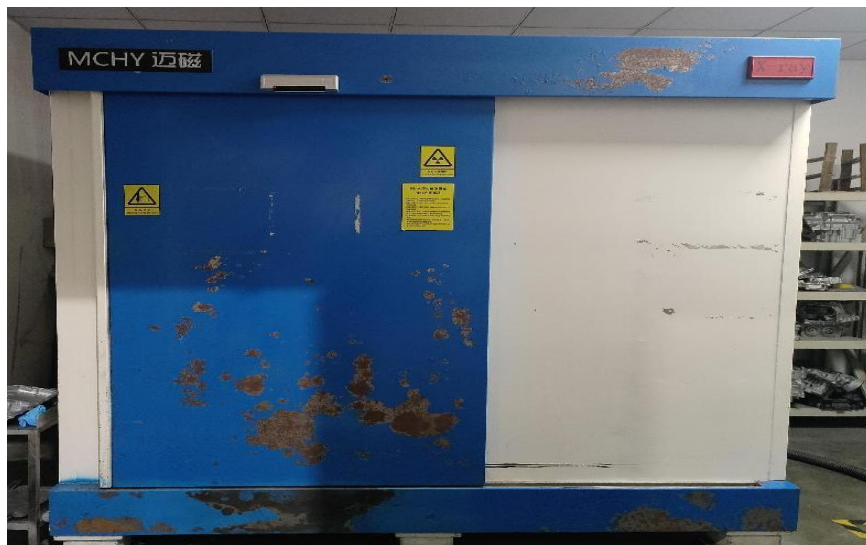
图 2-5 本项目 X 射线实时成像系统整体外观图
