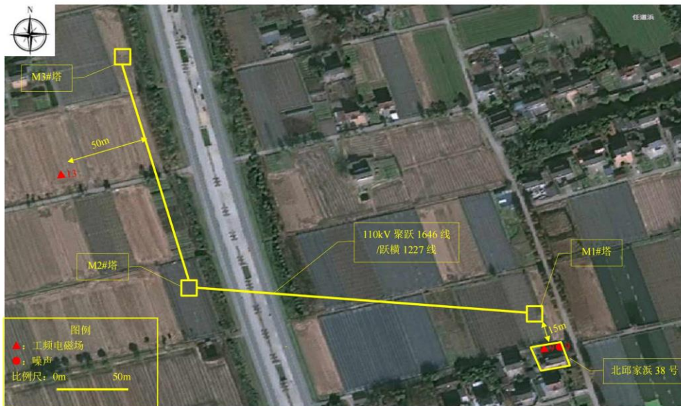
图 4、工程工频电磁场及噪声监测布点图 4
