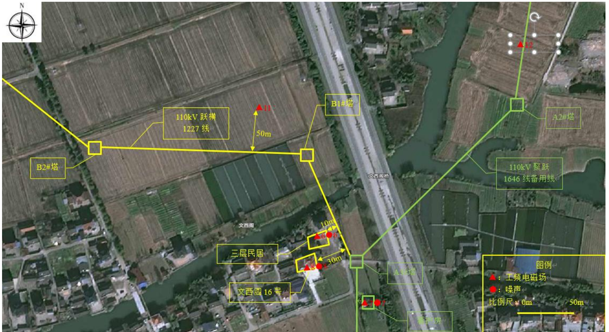
图 7-2、工程工频电磁场及噪声监测布点图 2
