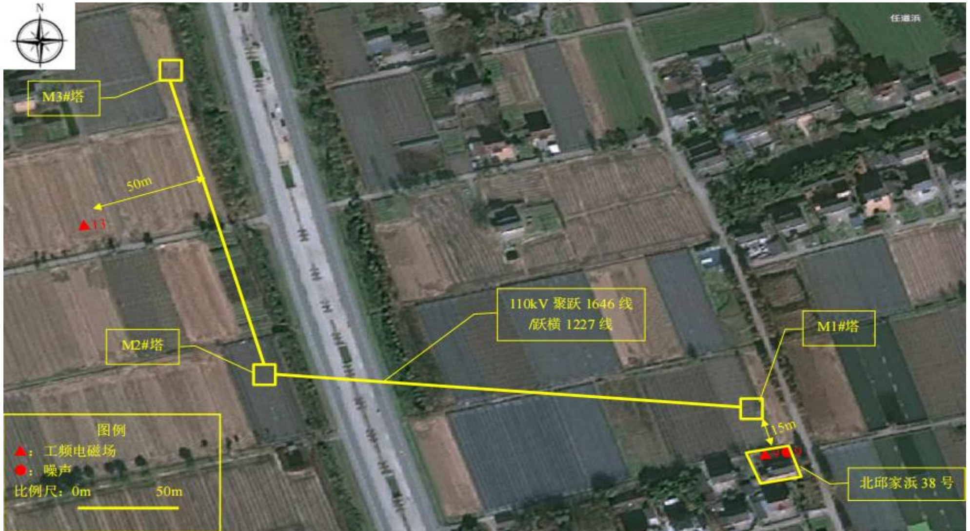
图 7-3、工频电磁场及噪声监测布点图 3
