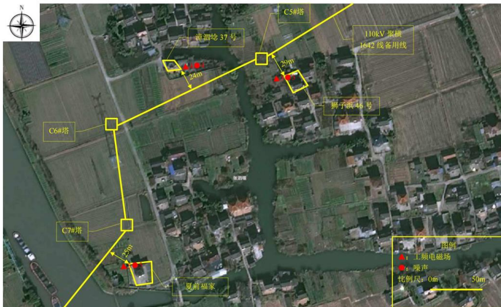
图2、工程工频电磁场及噪声监测布点图2
