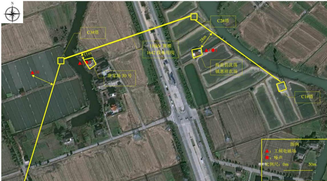
图1、工程工频电磁场及噪声监测布点图1
