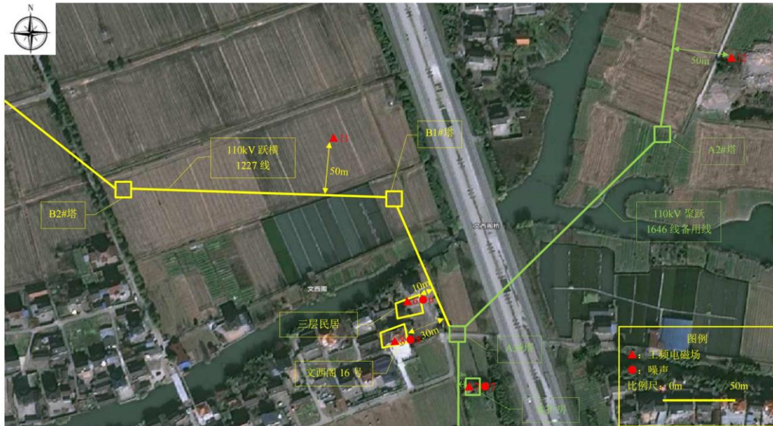
图 3、工程工频电磁场及噪声监测布点图 3
