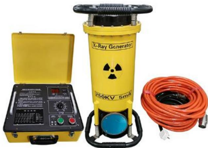
图 9-2 典型的 X 射线探伤外观示意图
