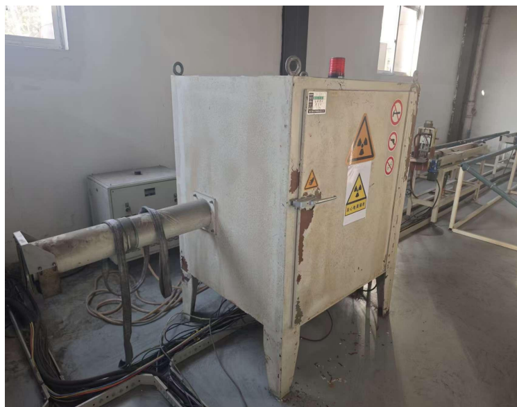
图 2-4 本项目 X 射线实时成像检测系统整体外观图
