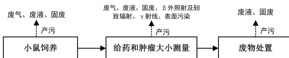
图 9-7 药效实验工艺流程及产污环节图
