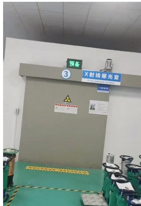
图 16 测试间外安全警戒线
