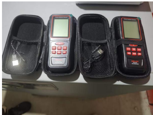
图 9 个人剂量报警仪
