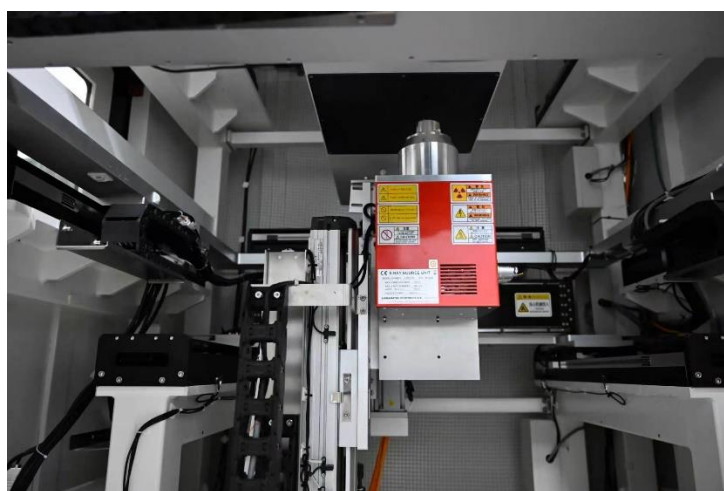
图 9-2 XO 1000 型 X 射线实时成像检测系统设备内部结构图
