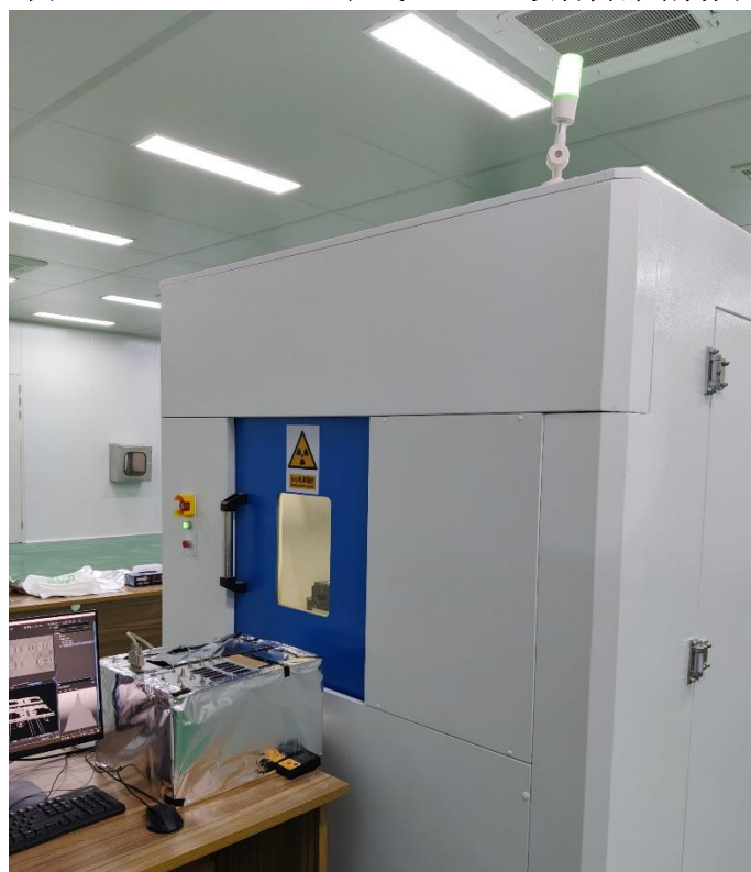
图 9-12 ICT 1000 型离线工业 CT 设备外观图
