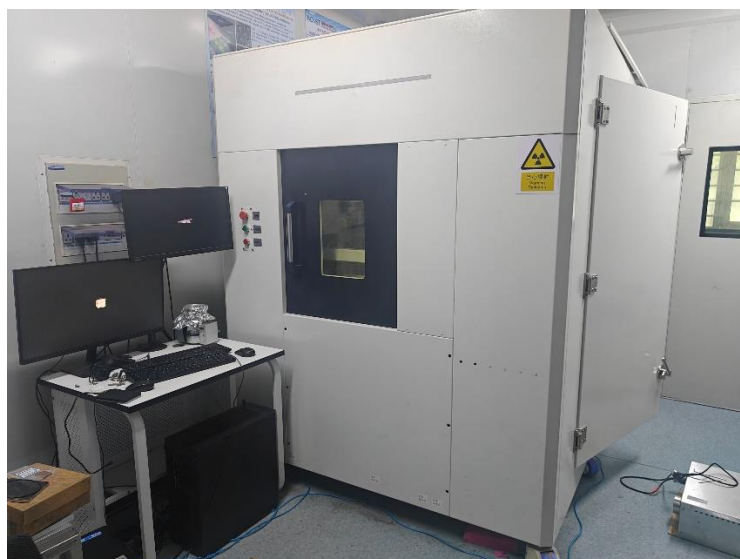
图 9-1 XO 1000 型 X 射线实时成像检测系统设备外观图
