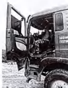
方向盘操纵力检测中工作照
