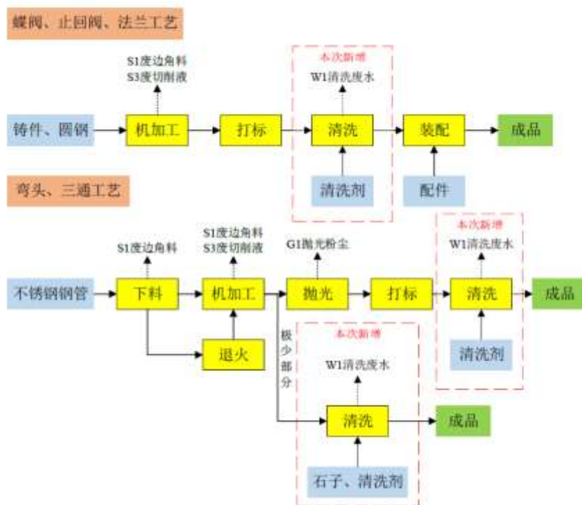
图 3-4 主要工艺流程及产污环节图
